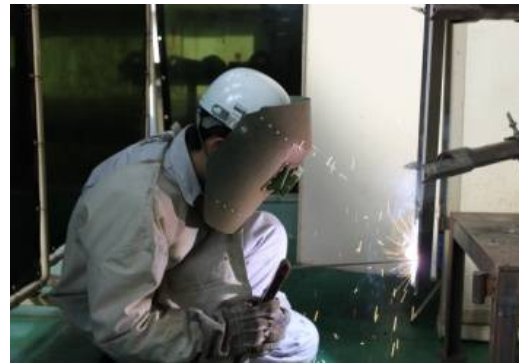
アーク溶接作業
