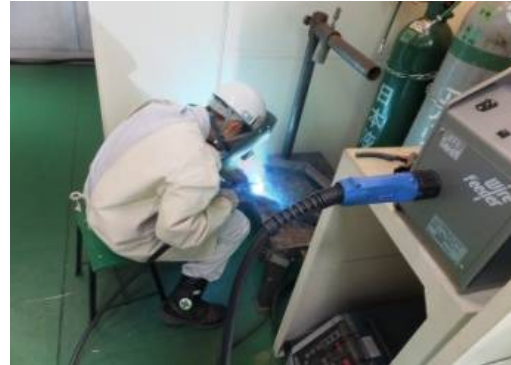
半自動溶接作業
